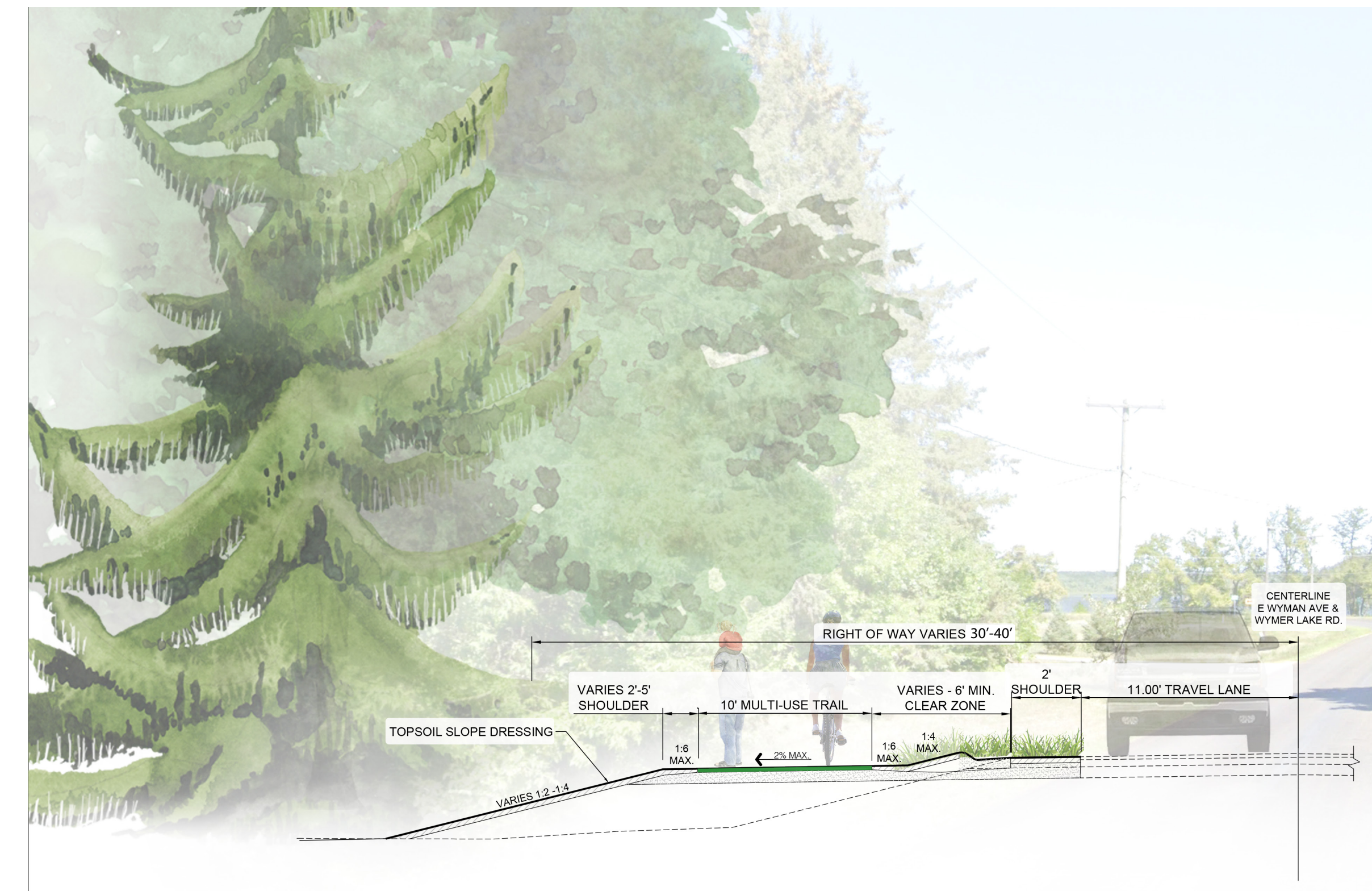
TYPICAL SECTION 2 - E. Wyman Ave & E. Wymer Lake Rd.
